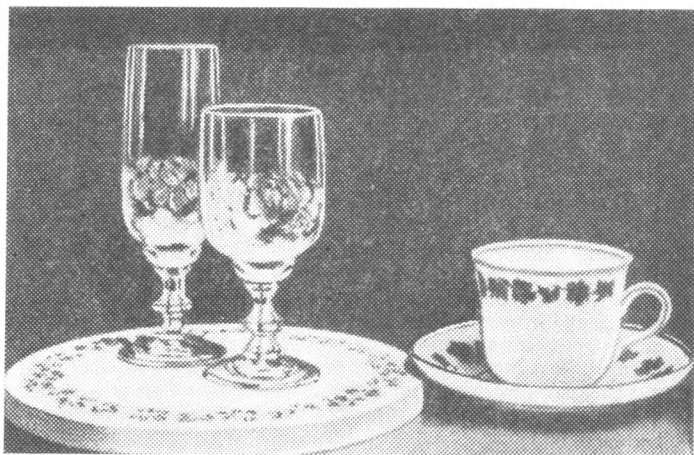
Рис. 4.41. Изготовление узора на стекле, фарфоре и деревянных тарелках путем облучения \text{CO}_2 -лазером [37]
